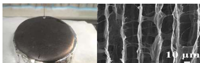
Рис. 9. Нанопористый графен с открытыми лабиринтовыми каналами – нетривиальная капиллярная гидродинамика с непуазейлеским течением.
