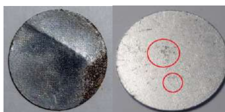
Рис. 8. Графеновые гибридные нанокompозиты на металлических микро-сетках.
